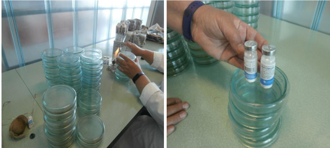
Рис. 9 Розлив поживного, стерильного середовища в чашки Петрі з додаванням стрептоміцину
