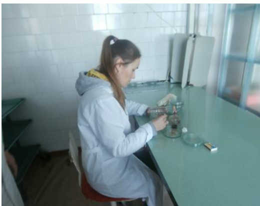
Рис. 8 Розміщення стерильного зерна в чашки Петрі на живильне середовище картопляно-глюкозного агару (КГА) та фіксація наявності чи відсутності макроконідій
