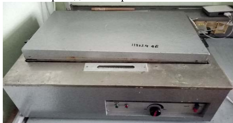
Рис. 19. Водяна баня для проварювання 4BK
