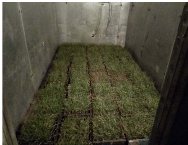
Рис. 5. Камери низьких температур КНТ- 1 та проморожування рослин
