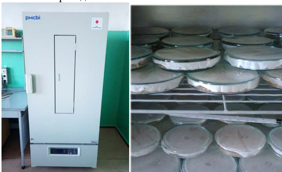
Рис. 9. Пророщування зерна у термостаті MIR-554-PE перед проморозуванням
