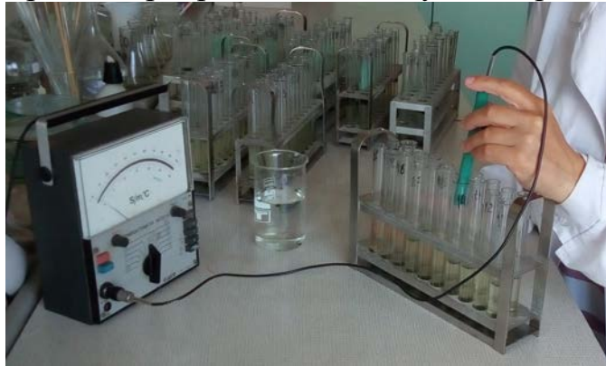
Рис. 18. Заміри електропровідності селекційних зразків кондуктометром N5721M
